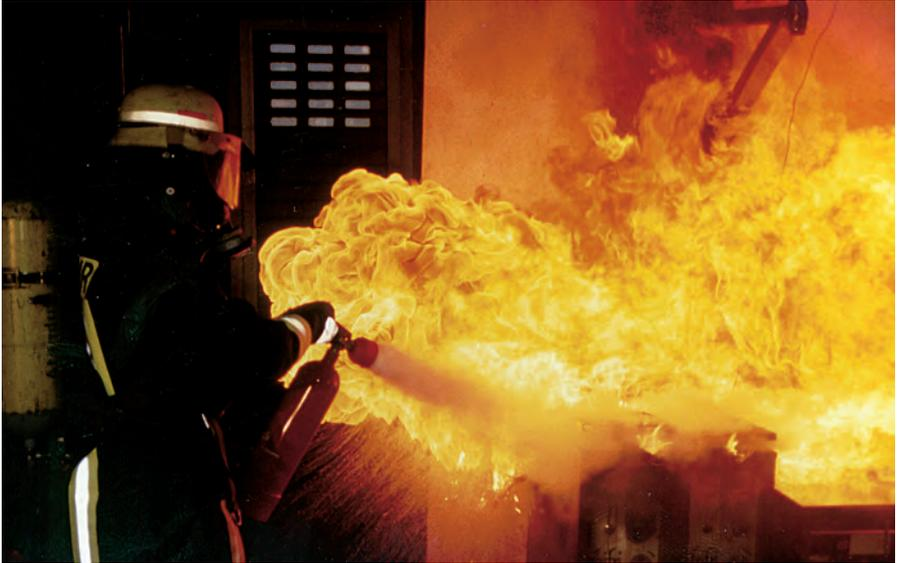
Abb. 7: Löschversuch einer brennenden Fritteuse mit einem CO<sub>2</sub> Löscher; ungeeignet, da durch den CO<sub>2</sub> Löscher die Flamme auffacht und der Kühleffekt nicht ausreicht um den Brand abzulöschen
