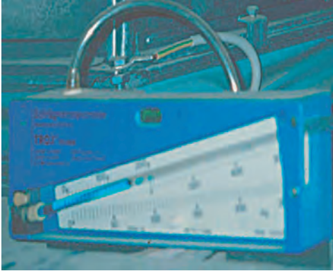
Abb. 6: Der Differenzdruck ist der Unterschied des Druckes vor und nach dem Luftfilter. Bei zu hoher Druckdifferenz (Istwert über maximalem Differenzdruck) ist der Filter zu ersetzen. Eine zu niedrige Druckdifferenz weist auf Leckagen hin. Kann die Störung nicht selbst behoben werden, z. B. durch Filterwechsel, ist umgehend eine Fachfirma mit der Instandsetzung zu beauftragen.
