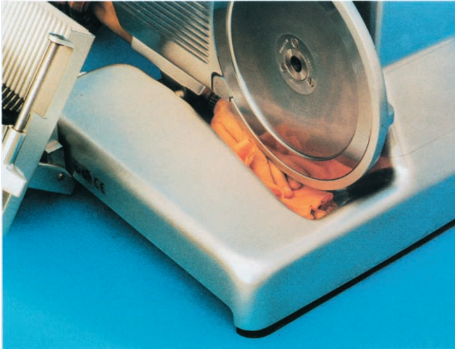
Abb. 10 Reinigung der Aufschnittschneidemaschine unterhalb des Messerschutzes mittels eines Tuches
