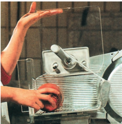
Abb. 7: Das Schneidgut wird bei angehobenem Schneidguthalter und zurückgezogenem Schlitten vor die Schlittenrückwand gelegt
